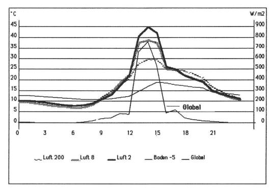
Abbildung 6: Tagesgang von Temperaturen und Globalstrahlung bei Hunzigen-Feucht vom 10. Juni 1986
