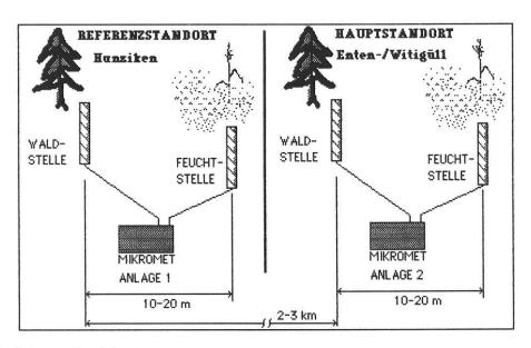
Abbildung 3: Schema des Messkonzeptes
