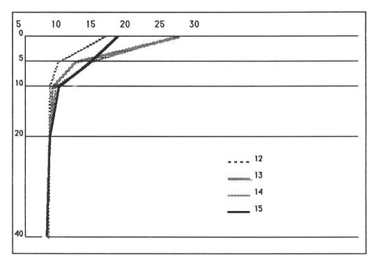
Abbildung 9: Tautochronen der Bodentemperatur bei Entengüll-Feucht vom 1Q. Juni 1986. (Abszisse: Bodentemp. in °C; Ordinate: Bodentiefe in cm; 12–15: Stundenangabe)
