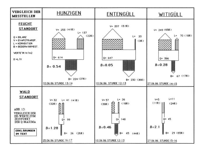
Die Graphiken erlauben kurz folgende Schlüsse: Der Energieumsatz ist an den durch ein Laubdach abgeschirmten Waldmessstellen generell kleiner, der Boden daselbst ist trockener. Von den Feuchtstellen ist Entengüll die am besten mit Wasser versorgte (%-Anteil von V am grössten), Hunzigen-Feucht aber jene mit dem grössten Energieumsatz, weil bei ihr die Bäume am wenigsten Licht abschirmen.
