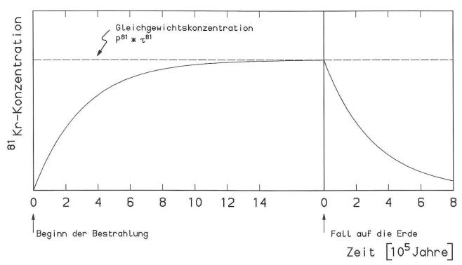
Abbildung 3: Zeitliche Entwicklung der Konzentration von <sup>81</sup>Kr nach dem Beginn der kosmischen Bestrahlung (links) und nach dem Fall auf die Erde (rechts).
