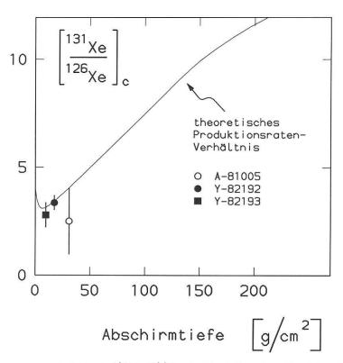
Abbildung 6: Kosmogenes Verhältnis <sup>131</sup>Xe/<sup>126</sup>Xe als Funktion der Abschirmtiefe (nach HOHENBERG et al., 1978). Die Messwerte für die drei Mondmeteorite entsprechen Abschirmtiefen von < 40 g/cm<sup>2</sup> für A-81005, 17 g/cm<sup>2</sup> für Y-82192 und 10 g/cm<sup>2</sup> für Y-82193.
