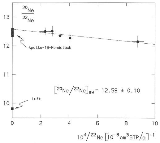
Abbildung 4: Diagramm <sup>20</sup>Ne/<sup>22</sup>Ne gegen 1/<sup>22</sup>Ne für die Korngrössenfraktionen von A-81005, 51. Der Achsenabschnitt entspricht dem Sonnenwindverhältnis, wie es in Apollo-16-Mondstaub gemessen wird. Der Wert für Luft-Ne liegt deutlich tiefer.
