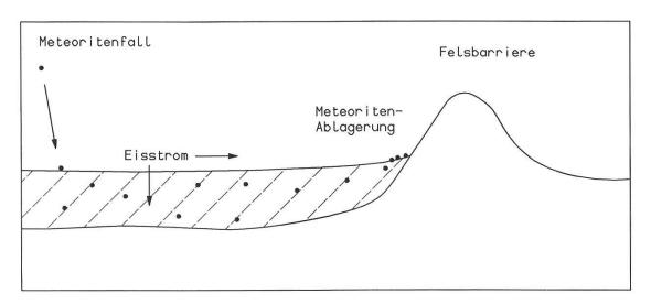
Abbildung 2: Mechanismus des Meteoritentransports im antarktischen Eis. Meteorite, die im Innern des Kontinents auf das Eis fallen, werden im Eisstrom begraben und mittransportiert, bis sie vor einer Felsbarriere wieder an die Oberfläche gelangen und sich dort ansammeln.
