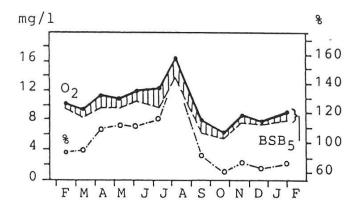
Abbildung 2: Sauerstoff- und BSB<sub>5</sub>-Gehalte in mg O<sub>2</sub>/1 sowie O<sub>2</sub>-Sättigungswerte in Prozent bei Probestelle 3 (Methode <sup>15</sup>).
