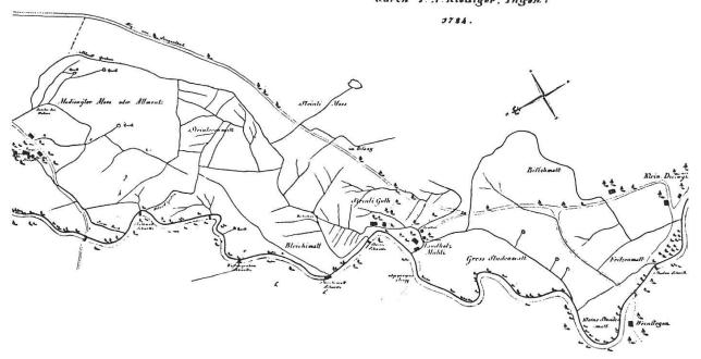
Abbildung 5: Wässerungsplan von Riediger, 1724. Grabensystem und Grundwasserquellen in den Wässermatten zwischen Madiswil und Kleindietwil.
