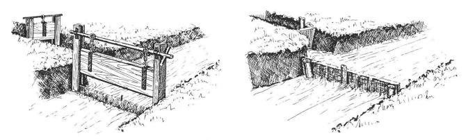
Abbildung 3: Schemata der Wasserverteilwerke: Links Schwelle und Zugbrütsche in Hauptgraben, in Seitengraben einfache Staubrettbrütsche. Rechts einfache Stauladen-Verteiler in Nebengräben. (Zeichnungen Urs Zaugg)
