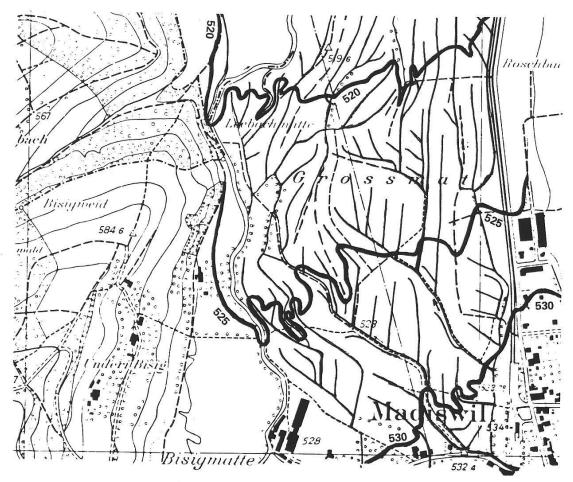
Abbildung 4: Madiswil, Grossmatt. Beispiel von Wässermatten-Isohypsen (Höhenkurven 5/5 m). Zufolge Ablagerung aus dem Wässerwasser entstehen längs den Gräben Erhebungen in Form von Rükken, die grössten bis einige Meter hoch. Sie zeichnen sich im Kurvenbild des Plans 1:5000 deutlich ab. Hier Massstab 1:10 000. Reproduziert mit Bewilligung V + D vom 13.10.1982.
