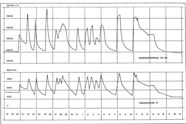
Abbildung 9: Grossversuch von Madiswil zur halbnatürlichen Grundwasseranreicherung mittels Mattenwässerung. August/September 1974. Oben die Versickerungsmengen, darunter die Reaktionen von Grundwasserspiegel und -Erträgen in der Grundwasserfassung Madiswil der Gemeinde Langenthal.
