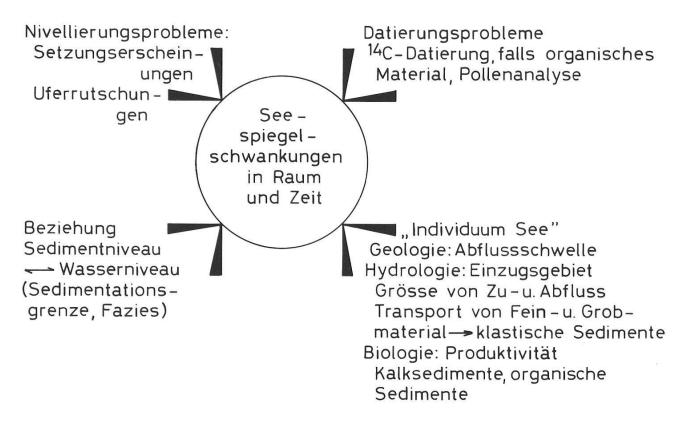
Abb. 3: Die genaue Erfassung von Seespiegelschwankungen hängt von Problemen des Nivellements, der Datierung, der Bedingtheiten der Sedimentationsgrenze sowie der lokalen Verhältnisse ab.
