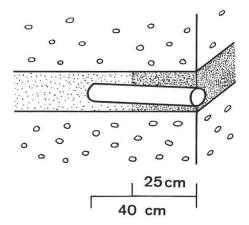
Abb. 8: Schnitt durch eine vorn verfestigte Weichsandschicht mit eingelegtem Drainageröhrenstück.
