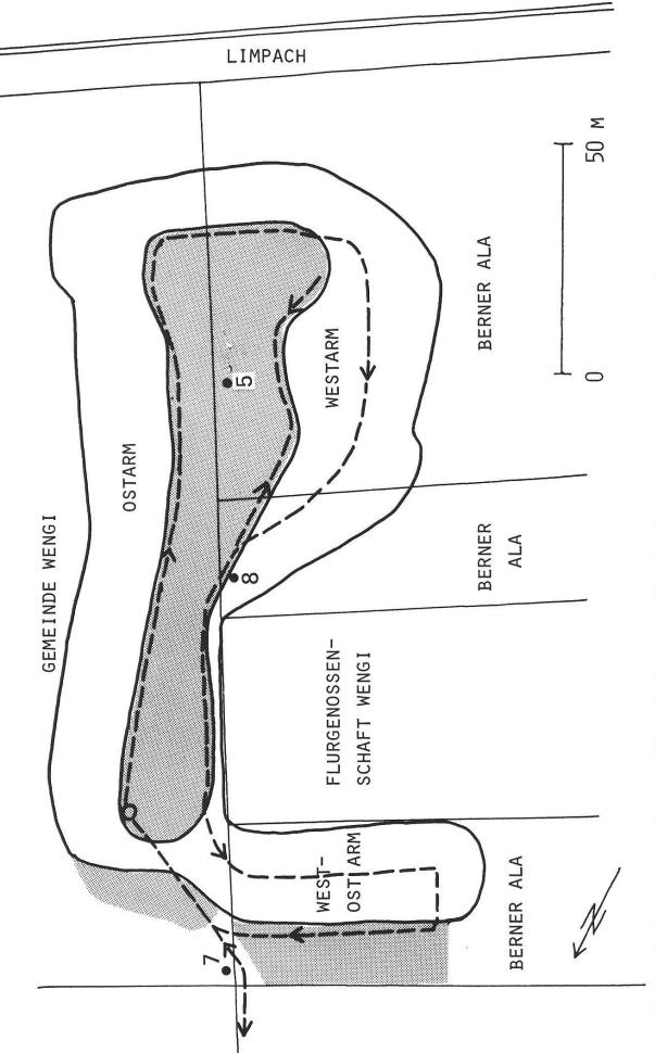
Abbildung 6: Die neu ausgebaggerte Wasserfläche im nördlich des Limpaches gelegenen Reservatsteil. Legende: dicke Linie = Grenze der Wasserfläche, dicke gestrichelte Linie = Weg des Baggers zur Ausbaggerung, nicht ausgefüllter Kreis = Beginn der Arbeiten, punktierte Fläche = Aushubmaterial, dünne Linie = Parzellengrenzen, ausgefüllte Kreise = Standorte Abbildung 5, 7, 8.
