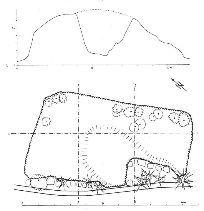
Abb. 12 Topographische Aufnahme des Dählisandhubels mit 1 Längenprofil und 2 Querprofilen (von Forstingenieur Th. Aeberhard)
