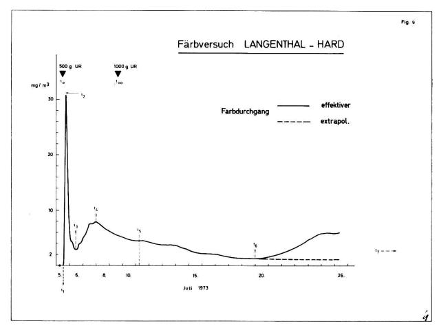
Fig. 9 Zweimalige Anwendung des gleichen Farbstoffes im gleichen Versuch. Die Möglichkeit der quantitativen Erfassung des Farbstoffes ist dabei Bedingung.  $t_0 = 1$ . Einspeisung,  $t_{00} = 2$ . Einspeisung,  $t_1 = \text{Beginn}$  des Farbdurchganges im Versuchsbrunnen,  $t_2 = 1$ . Maximum,  $t_4 = 2$ . Maximum,  $t_5 = 50 \, \text{m/o}$ -Grenze,  $t_6 = \text{Beginn}$  des Farbdurchganges aus 2. Einspeisung,  $t_7 = \text{Ende}$  des Farbdurchganges.
