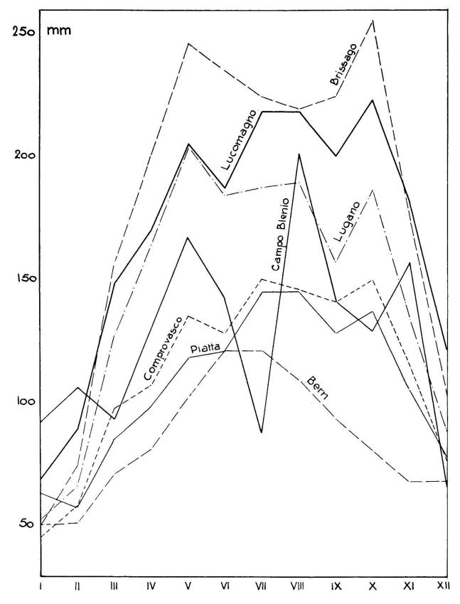
Fig. 3 Monatsniederschläge einiger Vergleichsstationen, MZA-Periode 1901—1940. Lucomagno = auf Gebietsniederschlag reduzierte Werte Olivone. (Aus: Verfasser, 1961) Campo Bl.: 1944—1955.
