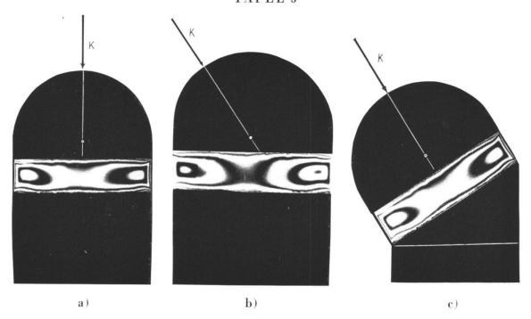
Abb. 2 Spannungsoptischer Modellversuch zur Demonstration der Beanspruchung des Epiphysenknorpels.
