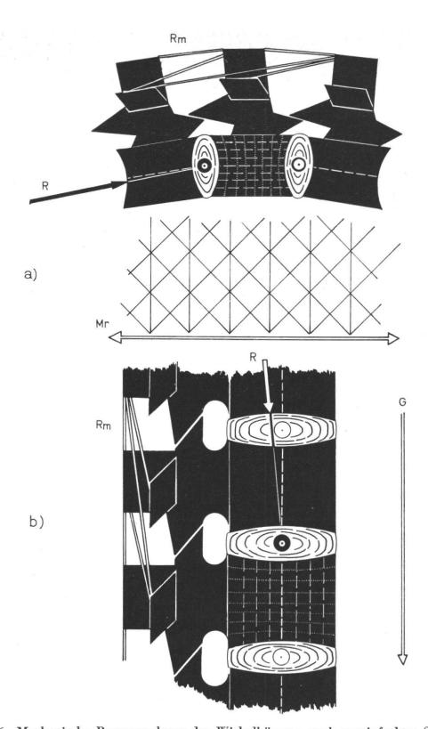
Fig. 16 Mechanische Beanspruchung der Wirbelkörper; stark vereinfachtes Schema.
