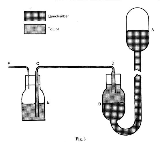
Da im beschriebenen Mikro-Barometer neben dem Quecksilber noch eine sehr leichtbewegliche Flüssigkeit angewendet wird, muß es auf der Seite des äußern Luftdruckes durch eine Kapillare F geöffnet sein, damit die Verdunstung auf ein Minimum beschränkt bleibt.
