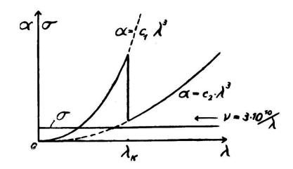
Abb. 2. Wellenlängenabhängigkeit von Absorption und Streuung.
