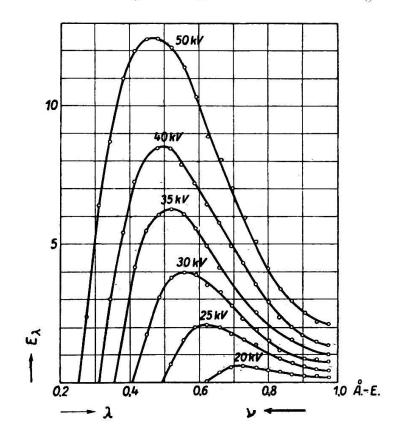
Abb. 1. Energieverteilung der Bremsstrahlung.
