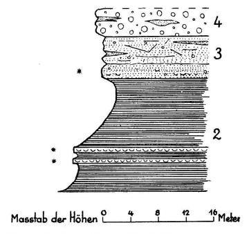
Fig. 6. Stratigraphisches Profil Unteraargraben.
