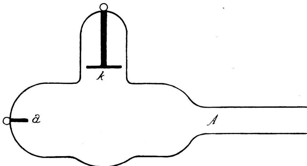
gegenüber der Kathode wurde angebracht, um das zu bestrahlende Pulver durch Schütteln der Röhre leicht an die Stelle der intensivsten Wirkung der Kathodenstrahlen bringen zu können.
