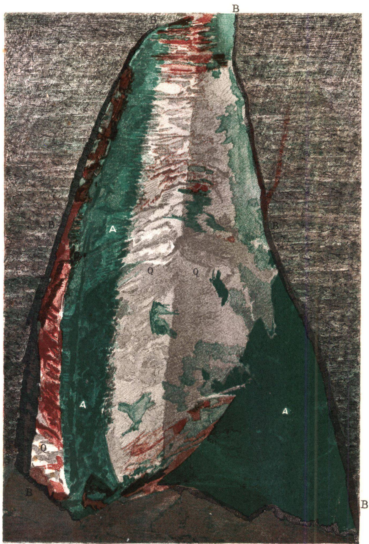
Fig. 9. Polirter Einschnitt in den sogen. Nebenstamm. (Siehe Taf. V. Fig. 7.) in natürlicher Grösse. A. Amphibolit. Q. Quarz. B. Biotithaut.
