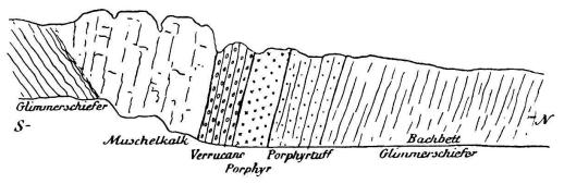
Fig. 27. Schematisches Querprofil der Verwerfung von Voldomino.
