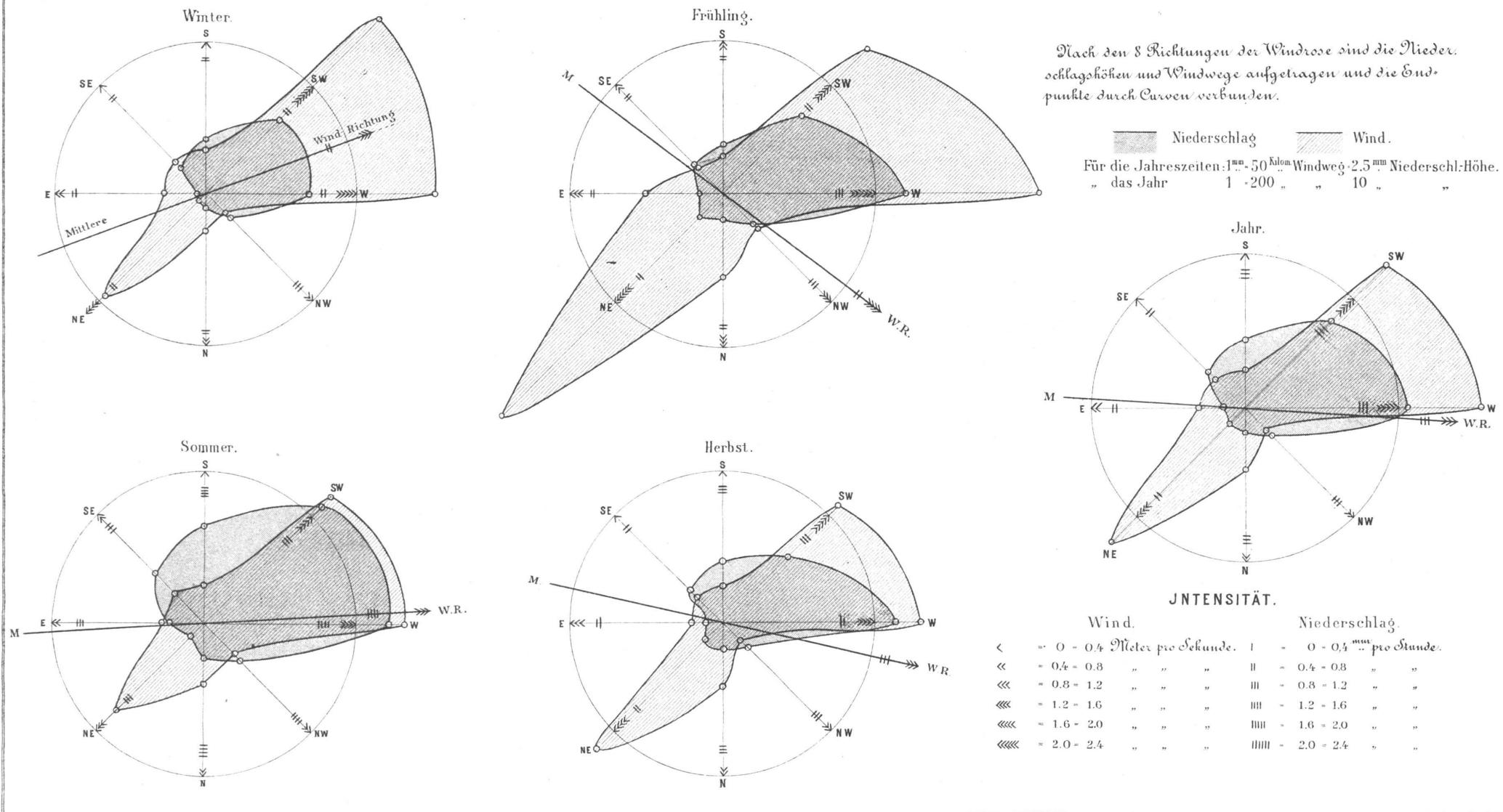
Nach den 8 Richtungen der Windrose sind die Niederschlagshöhen und Windwege aufgetragen und die Endpunkte durch Curven verbunden.
