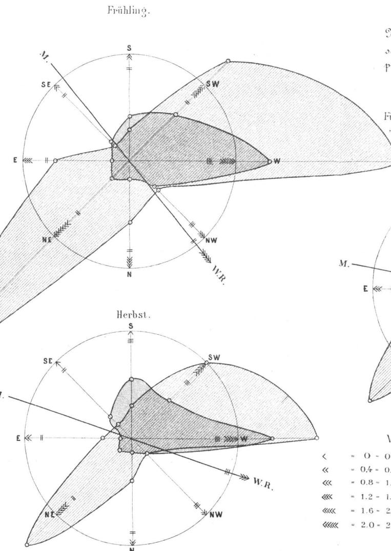
Nach den 8 Richtungen der Windrose sind die Niederschlagshöhen und Windwege aufgetragen und die Endpunkte durch Curven verbunden.
