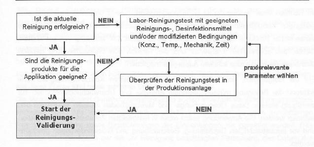
Abbildung 5: Beispiel eines Auswahlschemas für die Qualifikation eines Reinigungsmittels
