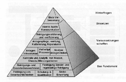
Abbildung 3: Pyramidenmodell für die Phasen einer Reinigungsvalidierung
