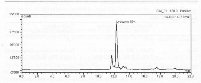
Abbildung 1 LC-MS-Chromatogramm von Emmentalerkäse, hergestellt mit Lysozym (z=10+), bestimmter Gehalt: 240 mg/kg
