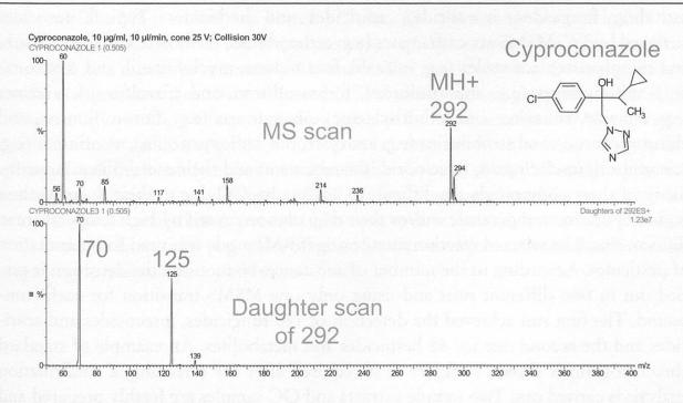
Figure 3 Optimisation of MSMS parameters
