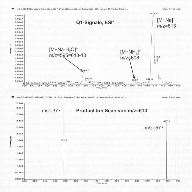
Abbildung 2 Massenspektrum von Lasalocid mit positiver Elektrospray Ionisierung (ESI+). Oben: Ionisierungsprodukte von Lasalocid. Unten: Fragmentierung von Lasalocid-Natrium mit m/z=613. Die resultierenden Fragmentionen m/z=377 und m/z=577 wurden für die Quantifizierung verwendet
