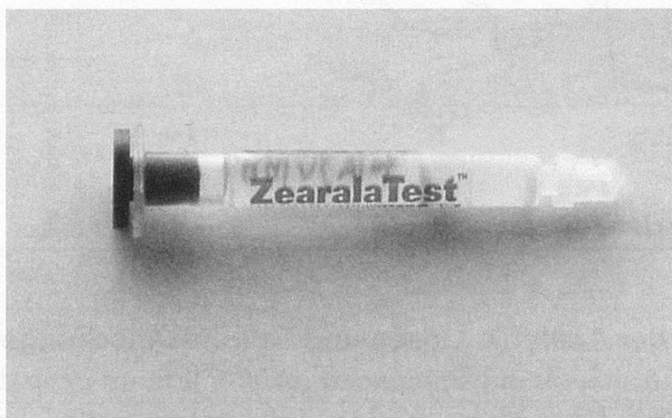
Abbildung 2 Clean up ausgeführt mit Immunoaffinitätskartusche
