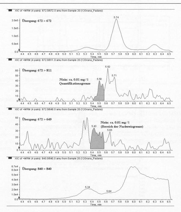
Abbildung 4 Nullprobe Grana Padano mit LC/MS/MS
