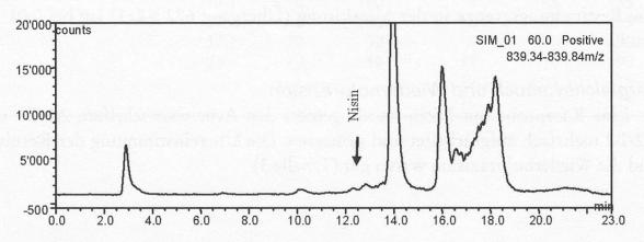
Abbildung 3 Nullprobe Grana Padano mit LC/MS
