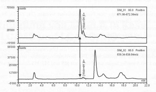
Abbildung 1 Matrixinterferenz auf dem Signal m/z 672 mit LC/MS
