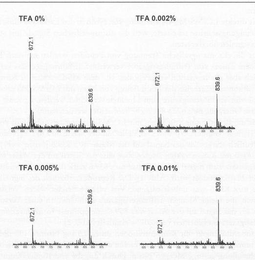
Abbildung 2 Einfluss der Trifluoressigsäure-Konzentration auf die Ladungsverteilung, LC/MS, Intensitätsskala (Ordinate) bei allen vier Massenspektren gleich
