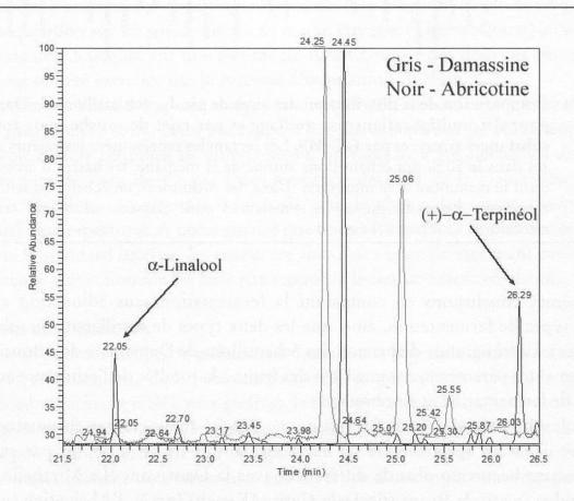
Figure 2 Chromatogramme GC-MS de l'Abricotine superposé à celui de la Damassine. L'α-Linalool a un pic à 22,05 et le (+)-α-Terpinéol à 26,29. A 25,06, le benzoate d'éthyle a une aire plus grande chez la Damassine
