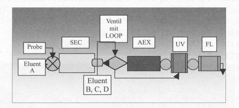
Abbildung 2 Das Schema der verwendeten HPLC-Apparatur
