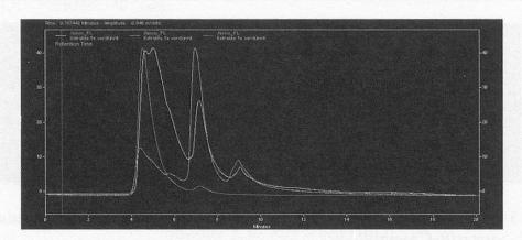
Abbildung 4 Die SEC-Chromatogramme der Extrakte «Weizen», «Gerste» (je 5× verdünnt) und «Soya» (40×) sind in dieser Abbildung einander überlagert (Detektion: FL (em295nmlex344nm, Eluent A), eingespritztes Volumen: 30 µl, Fluss 1,75 ml/min)
