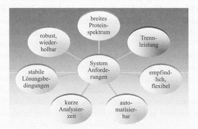
Abbildung 1 Anforderungen an das HPLC-Trennsystem zur Bestimmung von Proteinmustern in Lebensmitteln oder Lebensmittel-ähnlichen Matrizen
