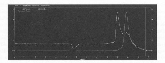
Abbildung 6 Die SEC-AEX-Chromatogramme der Proteine von α-LA (gelbe Kurve) und β-LG (blaue Kurve) aus zwei verschiedenen «Milcheiweiss»-Auftrennungen sind in der Abbildung festgehalten. Proteinkonzentrationen: 28–30 μg/ml je Protein, Detektion: FL (ex 295 nmlem 344 nm), eingespritztes Volumen: 30 μl
