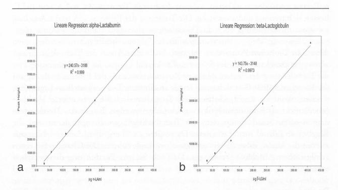
Abbildung 7 Lineare Regressionen von Peakhöhe vs. Proteinkonzentration von α-LA und β-LG, Proteinkonzentrationen: 30–450 μg/ml je Protein, Detektion: FL (ex 295 nmlem 344 nm), eingespritztes Volumen: je 30 μl
