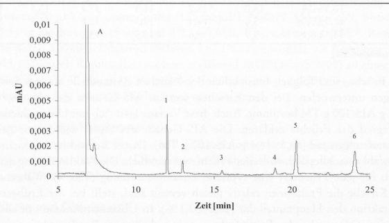
Abbildung 4 Kapillarelektrophoretische Trennung der Neutralzucker aus säurelöslichem Zellwandmaterial (HSP-Fraktion der Erdbeere, gefriergetrocknet) nach Hydrolyse (1 h, 121°C mit 72 % Schwefelsäure) und Derivatisierung mit ABEE; System: Biofocus 2000, BIO-RAD®; 438 mmol \* L-1 Borat, pH 10,0. 1=2-Desoxy-D-Ribose, 2=L-Rhamnose, 3=D-Xylose, 4=D-Glucose, 5=L-Arabinose, 6=D-Galactose, A=ABEE
