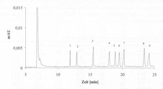
Abbildung 5 Elektropherogramm eines Monosaccharid-Standardgemisches (0,2 g/l) System: Biofocus 2000, BIO-RAD®; 438 mmol \* L-1 Borat, pH 10,0.
