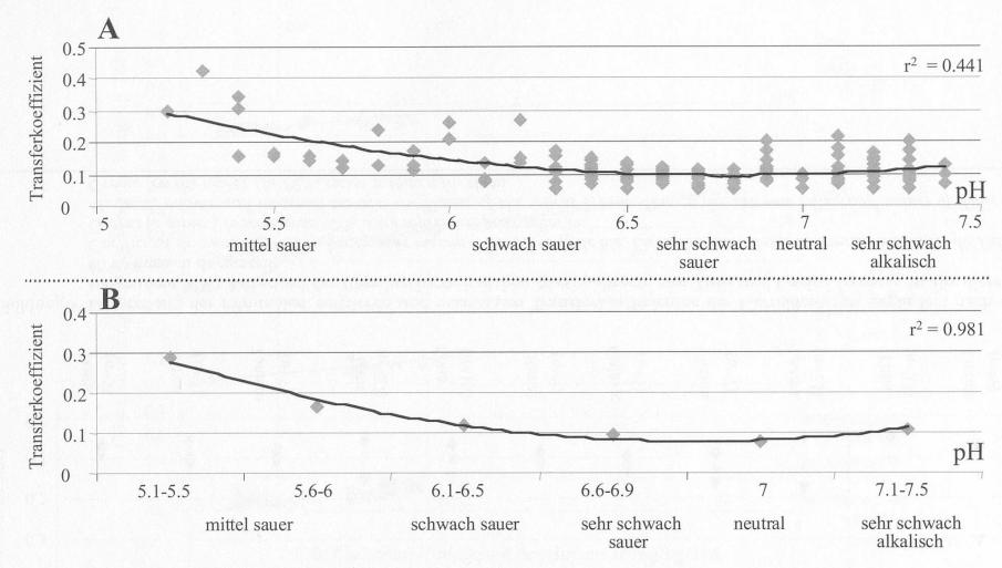
Abbildung 6 Transferkoeffizient in Abhängigkeit des pH-Wertes (in CaCl<sub>2</sub>-Lösung): In der oberen Graphik sind die Einzelwerte der Datenpaare angegeben, in der unteren die mittleren Transferkoeffizienten pro Reaktionszustand (22).
