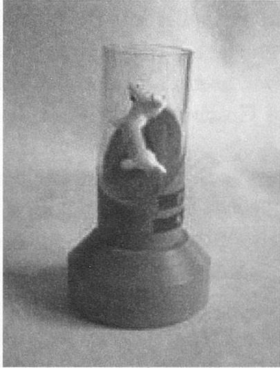
Zylinder zur Prüfung der Verschluckbarkeit von Spielzeug und quellbares Spielzeug vor und nach Wasserkontakt
