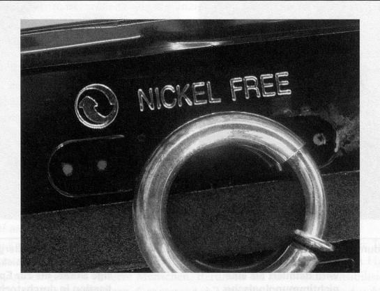
Abbildung 3 Der Begriff «nickelfrei» bezieht sich nicht auf den Gegenstand selbst, sondern auf die getestete Lösung. Korrekt müsste der Begriff «nickelabgabefrei» heissen, was soviel bedeutet, dass der getestete Gegenstand zwar Nickel enthält, Nickel aber nicht an eine Schweisssimulanz abgibt und der Prüfgegenstand dadurch auch keine Nickelallergien auslöst. Quelle: Kantonales Laboratorium Zürich
