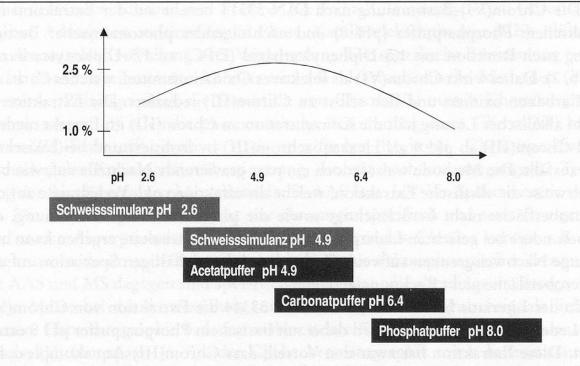
Abbildung 8 Puffersysteme bei pH 4,9 (Acetatpuffer), pH 6,4 (Carbonatpuffer) und pH 8 (Phosphatpuffer) sowie verschiedene Schweisssimulanzien bei pH 2,6 (§35 LMGB 82,10-1), 4,9 (EN ISO EN 105-E04) und 5,5 (EN ISO EN 105-E05) zeigen unterschiedliche Extraktionskapazitäten in Abhängigkeit vom pH. Bei pH 5 wurden bei einer Musterprobe bis 2,5% des extrahierbaren Chroms als Chrom(VI) extrahiert
