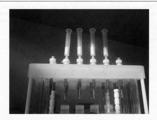
Abbildung 9 Festphasenaustauscher auf der Basis von Chromabond-NH<sub>2</sub> Aminopropylgruppen stellen wegen deren moderaten pK<sub>s</sub>- bzw. pK<sub>b</sub>-Werte je nach pH-Wert des Eluierungsmittels einen Kationen- bzw. Anionenaustauscher dar. Quelle: Kantonales Laboratorium Zürich
