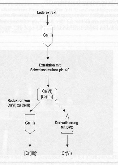
Abbildung 10 Die Doppelaustausch-Methode beruht auf der Annahme, dass negativ geladene Chrom-Komplexe im Lederextrakt vorhanden sind, und dass diese nach einem einfachen lonenaustauschschritt zusammen mit Chrom(VI) erfasst werden
