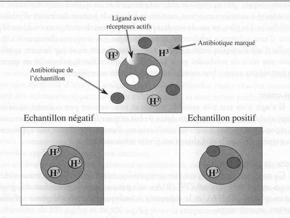
Figure 2 Illustration du principe de fonctionnement du Charm test (compétition)
