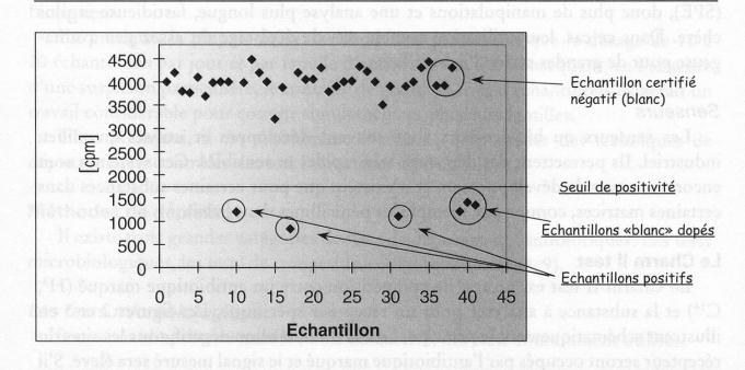
Figure 3 Représentation graphique du fonctionnement du Charm test et de la fixation du seuil de positivité
