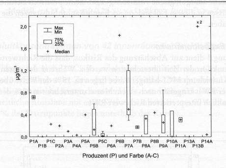
Abbildung 4 MCI-Raumluftkonzentrationen in Abhängigkeit der Anstrichstoffe
