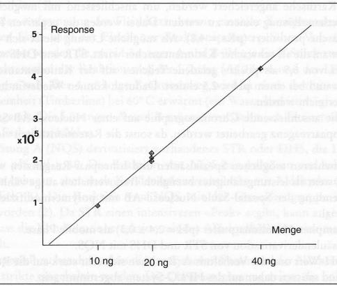
Abbildung 2 Kalibrierkurve von DHS zur Auswertung über externen Standard
