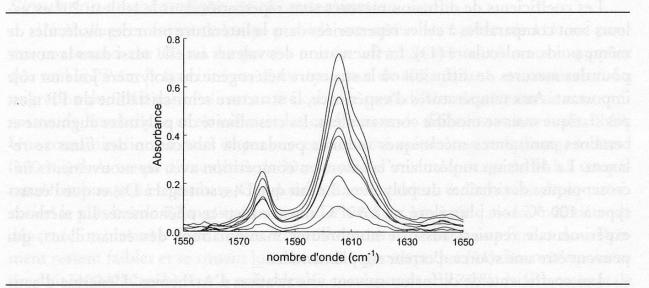
Figure 6 Spectres IR d'un film de PP pendant la diffusion du PMB à 50 °C. Mesures à 30 min,1 h, 2 h, 3 h, 4 h, 5,5 h et 14 h
