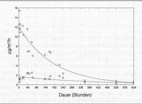
Abbildung 1 Zeitlicher Verlauf der experimentellen Isothiazolinonemission der Wanddispersion (Tabelle 1). O MCI (5-Chlor-2-Methyl-4-Isothiazolin-3-on); ☐ MI (2-Methyl-4-Isothiazolin-3-on).
