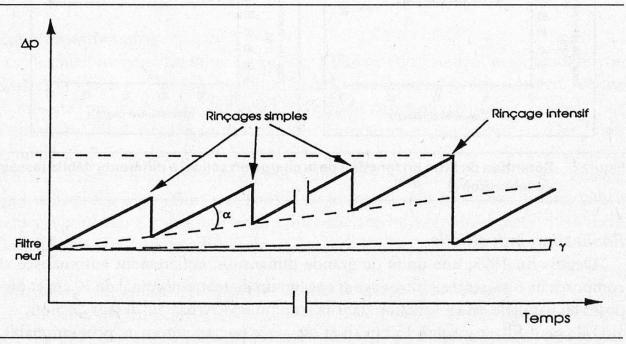
Figure 4 Présentation schématique de l'opération de décolmatage
