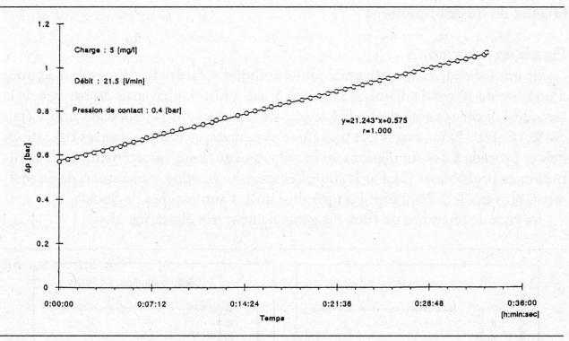
Figure 3 Profil hydraulique typique d'un essai de filtration en laboratoire
