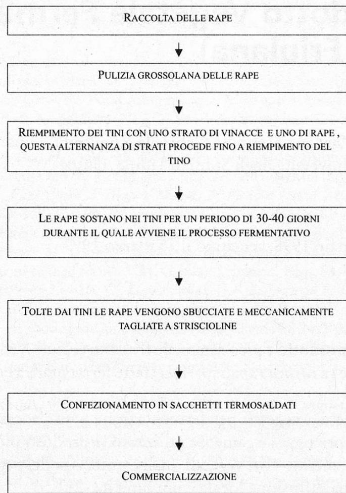
**Figura 1 Diagramma di flusso della produzione della «brovada»**
