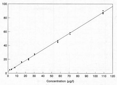
Fig. 4. Courbe de calibration de l'acétaldéhyde dans l'eau par HS-SPME-GC/FID
