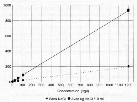
Fig. 2. Effet du NaCl en solution saturante sur l'équilibre liquide-vapeur et sur la sensibilité de la fibre Carboxen-PDMS 75 μm
