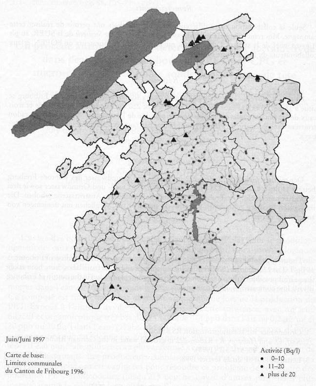
Fig. 2. Radon-222 dissous dans l'eau du Canton de Fribourg, 1:300 000
