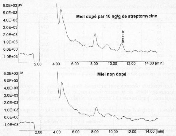
Fig. 3. Chromatogramme obtenu après extraction de 5 g de miel dopé par 0,01 mg/kg de streptomycine
