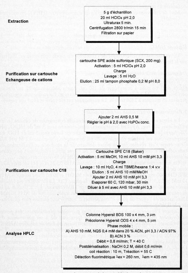
Fig. 1. Représentation schématique de l'ensemble du mode opératoire
