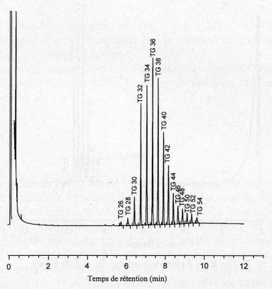
Fig. 6. Chromatogramme de la graisse de coprah
