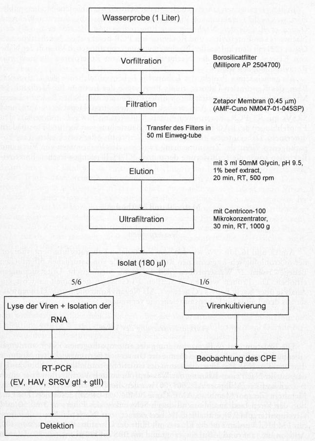
Abb. 1. Flussdiagramm des Isolationsprotokolls für enterische Viren
