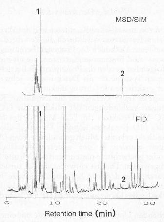
Abb. 2. GC-Chromatogramme von flüchtigen Schwefelverbindungen in einer UHT-indirekt-erhitzten Milchprobe (Purge & Trap®-Analysenmethode, parallele Detektion mit einem massenselektiven Detektor: oben im SIM-Modus (Modell HP 5972), unten Flammenionisationsdetektor (FID)).
