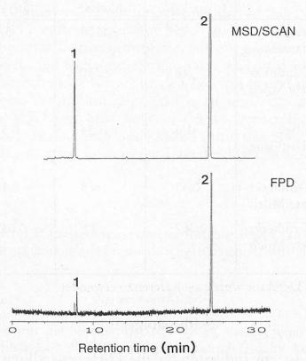
Abb. 3. GC-Chromatogramme von flüchtigen Schwefelverbindungen in einer wässerigen Standardlösung (Purge & Trap®-Analysenmethode, parallele Detektion mit einem massenempfindlichen Detektor: oben im SCAN-Modus, unten schwefelflammenphotometrischer Detektor (FPD)).
