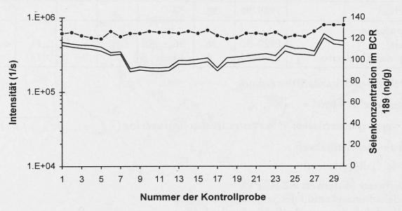
Abb. 1. Verlauf der Ionenintensitäten von <sup>82</sup>Se und <sup>78</sup>Se bei der Messung der Qualitätskontrollprobe BCR 189 (Sollwert 132 ± 10 ng/g) im Vergleich zur jeweils gemessenen Selenkonzentration (schwarze Punkte)
