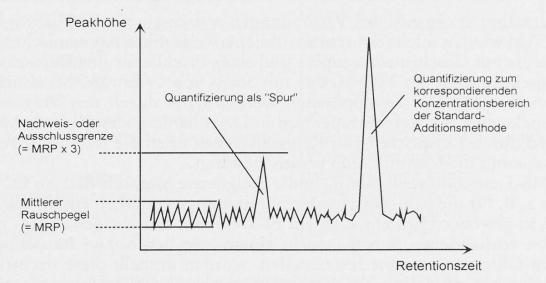
Abb. 1. Prinzip der Quantifizierung von positiv identifizierten Verbindungen
