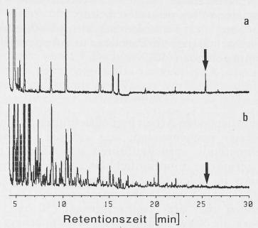
Abb. 2. Dynamische GC-MS-Dampfraumanalyse von Joghurt nature in Polystyrol- (a) und Glasbechern (b) Legende: ↓ = Monostyrol
