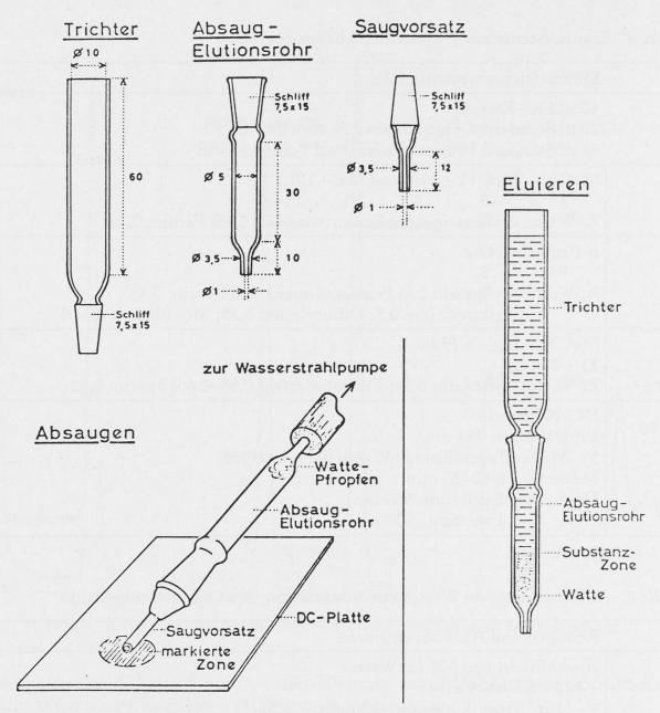
Abb. 4. Absaug-Elutionsvorrichtung für die Dünnschichtchromatografie
