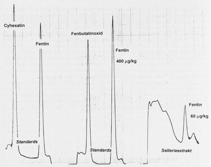
Abb. 3. Dünnschichtchromatogramme von zinnhaltigem Sellerieextrakt
