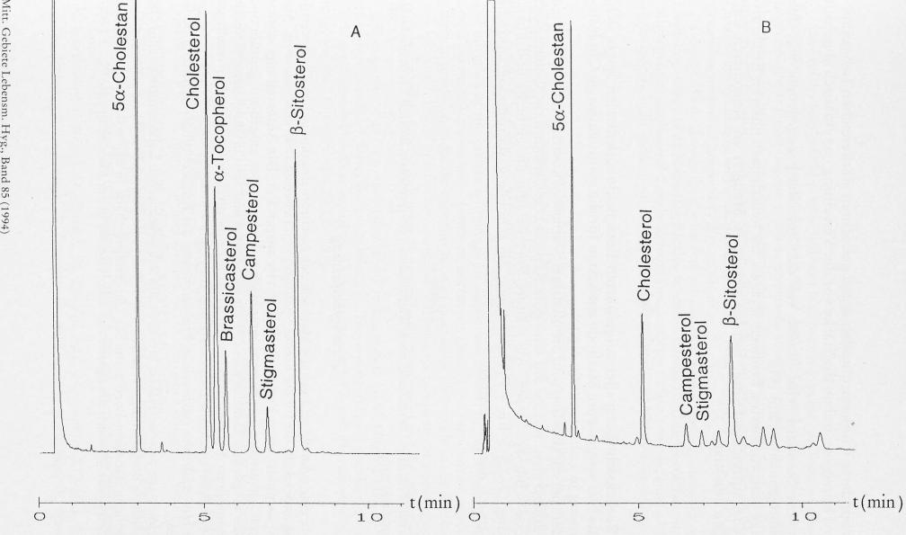
Abb. 3. Gaschromatogramme bei einer Ofentemperatur von 255 °C und einer Probengeber-Temperatur von 290 °C A = Standardlösung B = Mayonnaise
