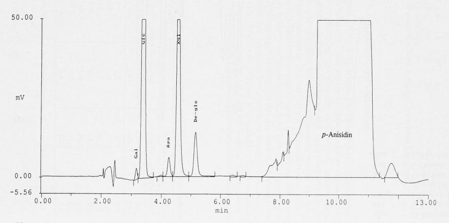
Abb. 4. Chromatogramm der N-p-Methoxyphenyl-glycosylamine der im UNF-Hydrolysat von Hirseschalen vorkommenden Neutralzucker
