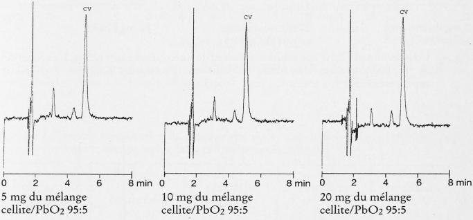
Fig. 3. Oxydation à pH 5,0 d'une solution standard de leuco cristal violet (25 μg/l) en fonction de la concentration du PbO<sub>2</sub> (Conditions chromatographiques: voir partie expérimentale)
