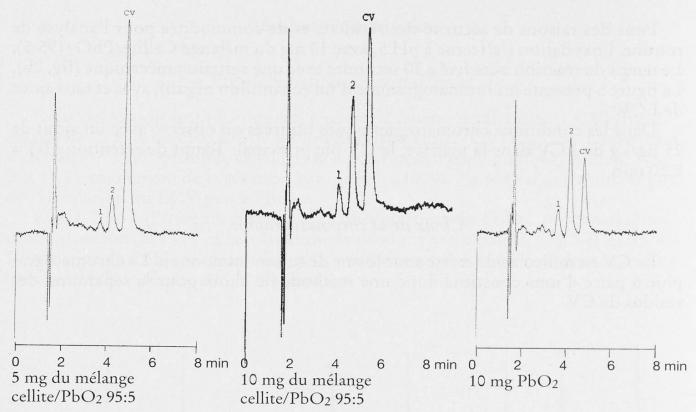
Fig. 4. Oxydation à pH 2,5 d'une solution standard de leuco cristal violet (25 μg/l) en fonction de la concentration du PbO<sub>2</sub> (Conditions chromatographiques: voir partie expérimentale)
