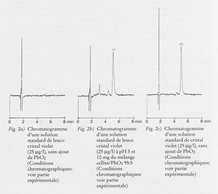
Pour des raisons de sécurité des résultats et de commodités pour l'analyse de routine, l'oxydation s'effectue à pH 5, avec 10 mg du mélange Cellite/PbO<sub>2</sub> (95:5). Le temps de réaction a été fixé a 30 secondes avec une agitation mécanique (fig. 2b). La figure 5 présente le chromatogramme d'un échantillon négatif, avec et sans ajout de LCV.
