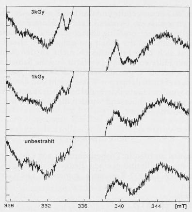
Abb. 2. ESR-Spektren von bestrahlten und unbestrahlten Erdbeeren
