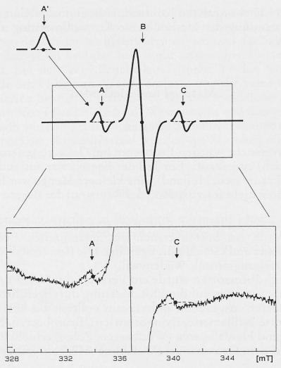
Abb. 1. oben: Schematische Darstellung eines ESR-Spektrums von bestrahlten Beeren; unten: zugehöriges ESR-Spektrogramm (Himbeeren, 3 kGy)
